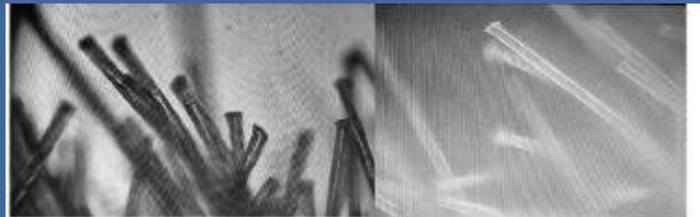
Abbildung 1 und 2 - Nylon-Hohlfasern am gebrochenen Ende der Teststüpfen.
